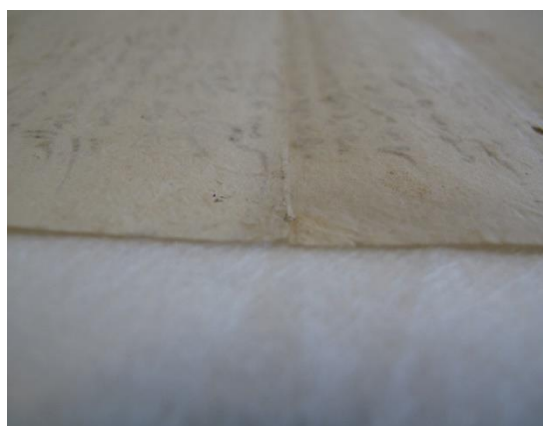
Figuras 8, 9 y 10. Mitigación de los pliegues mediante aplicación de agua cola (almidón muy diluido en agua) y espátula térmica a baja temperatura
