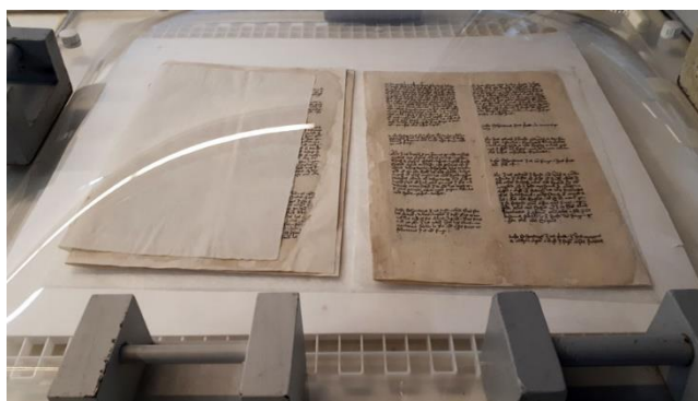
Figura 20: cámara de humectación
