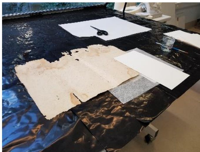
Figura 20: proceso de limpieza acuosa puntual en mesa de succión
