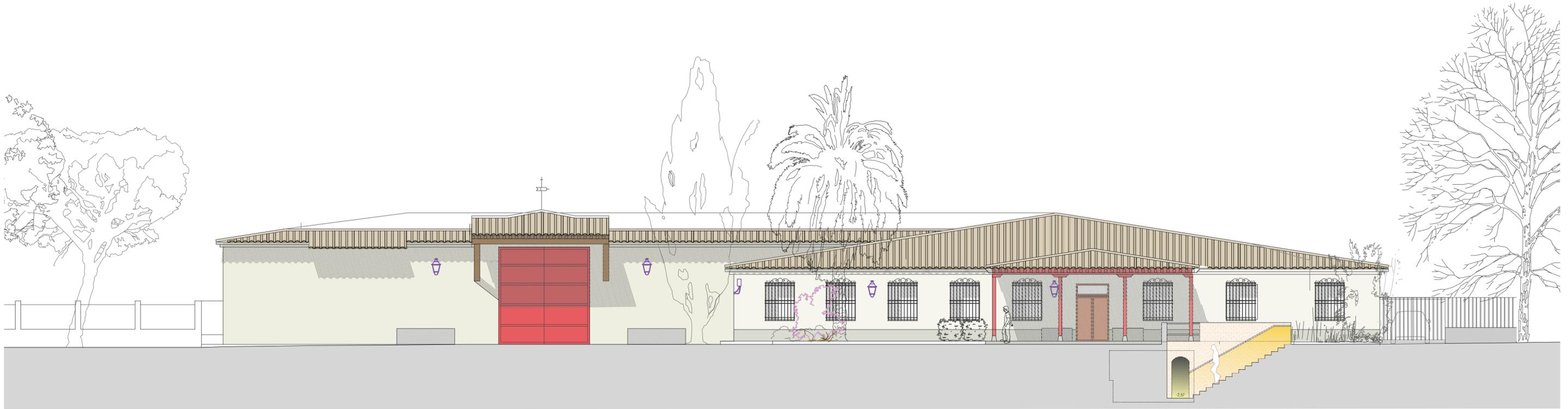
Limpieza de fachadas, repintado con pintura al silicato. Retirada de malezas, picado y repintado de humedades. Eliminación de objetos innecesarios.
