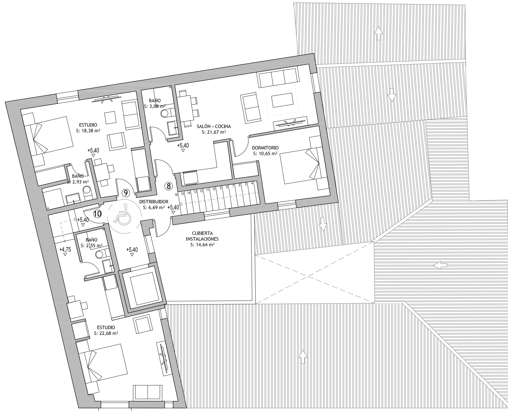
PLANTA SEGUNDA. ESTADO REFORMADO
