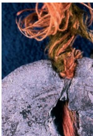
Los tratamientos más utilizados para eliminar los productos de corrosión del plomo, además de la limpieza mecánica, son la aplicación de ácidos, tales como nítrico diluido y el acético, o el método denominado Caley, que utiliza ácido clorhídrico y acetato amónico: resinas cambiadoras de iones y la reducción electroquímica y electrolítica.
