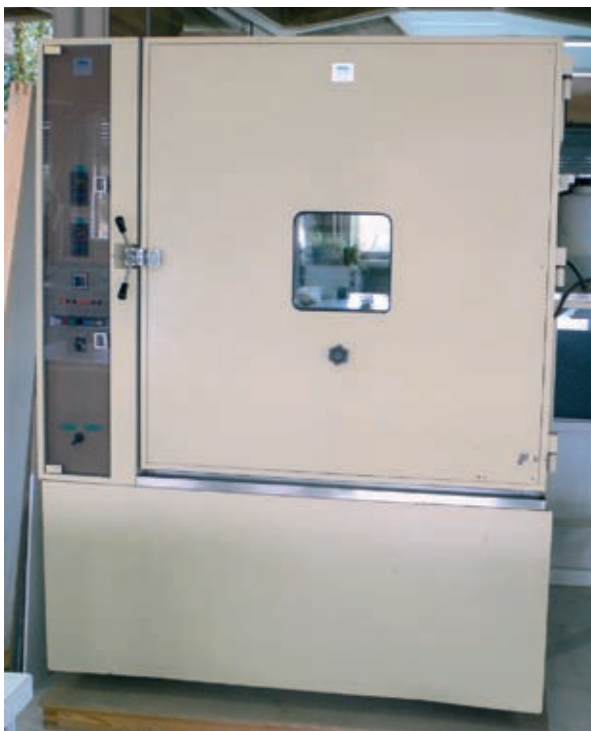
Cámara de humidificación
