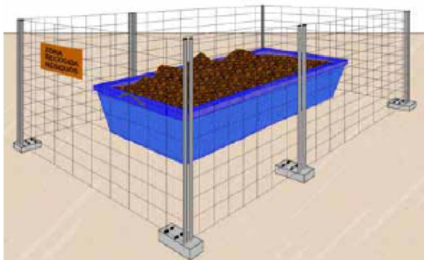
Contenedor deposito residuos en obra, con vallado perimetral.
