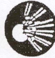
RIESGO DE EXPLOSION
